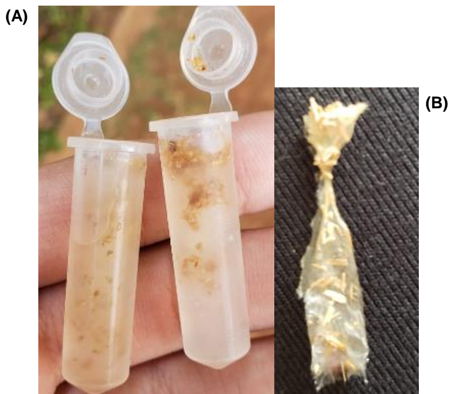
Figura 47: Imagem dos compósitos preparados . (A) Eppendorf da esquerda contendo fibras jovens e da direita contendo fibras senescentes, (B) compósito contendo fibras jovens após secagem em estufa 60°C.
