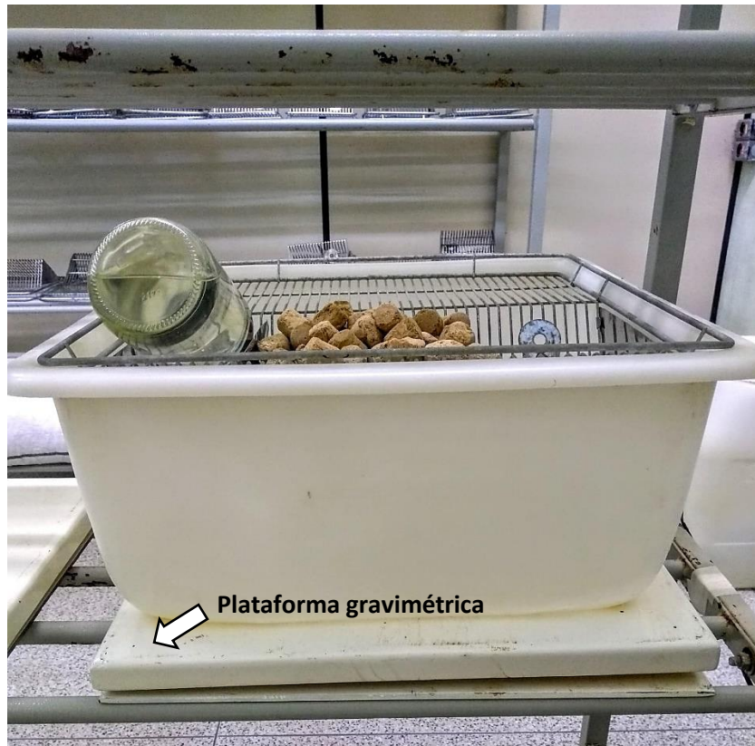
Figura 7A. A figura ilustra o aparato de gravimetria o qual a gaiola está posicionada sobre a plataforma de ferro para mensuração da atividade física espontânea diária.
