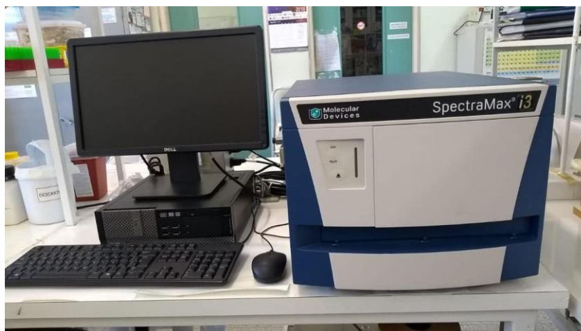
Figura 9. SpectraMax® i3 (Marca Molecular Devices) - Equipamento utilizado para ler as absorbâncias dos valores séricos à partir de espectrofotometria – Laboratório de Bioquímica e biologia molecular – Responsável: Profa. Dra. Heloísa Sobreiro Selistre de Araújo, UFSCar (São Carlos/SP).
