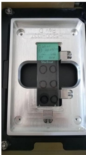
Figura 8C. Lâmina posicionada no suporte do ImageXpress para ser analisada.
