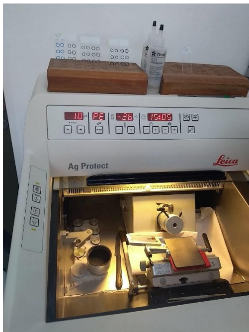
Figura 8A. Criótomo Leica utilizado para os cortes histológicos do músculo esquelético sóleo – Laboratório de imunohistoquímica – Responsável: Prof. Dr. Thiago Russo, UFSCar (São Carlos/SP).
