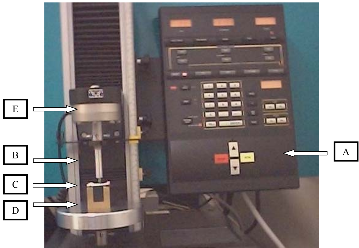
Figura 1: Máquina universal instron (modelo 4444) utilizado para o ensaio de flexão a três pontos em fêmur de rato. A: painel de controle; B: haste cilíndrica para a aplicação de carga (força); C: osso; D: suporte; E: célula de carga ligada à ponte de extensimetria.
