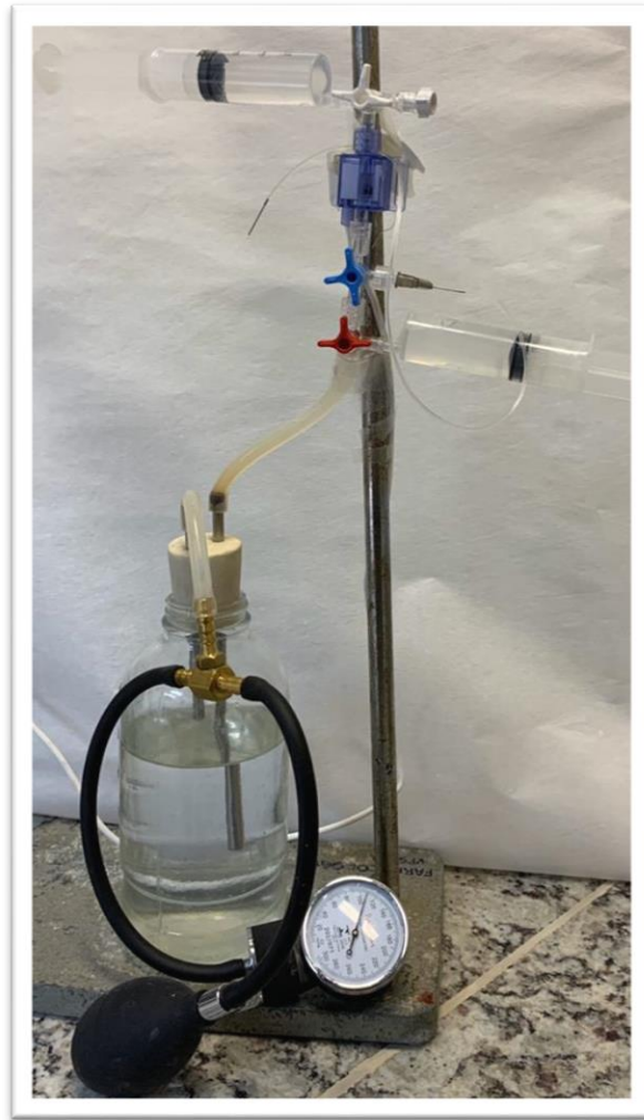
Figura 4. Sistema intermediário de selo d'água pressurizado, necessário para calibração do sistema e adequado registro das pressões.
