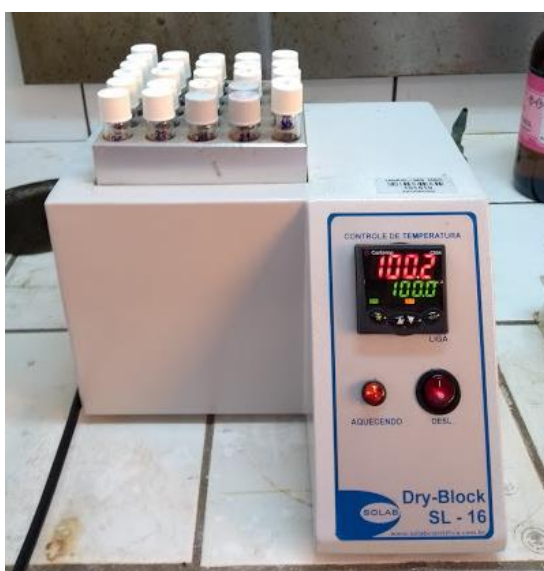
Figura 6. Digestão de biomassa seca de R. natans em sistema fechado em bloco digestor (Fonte: arquivo pessoal)
