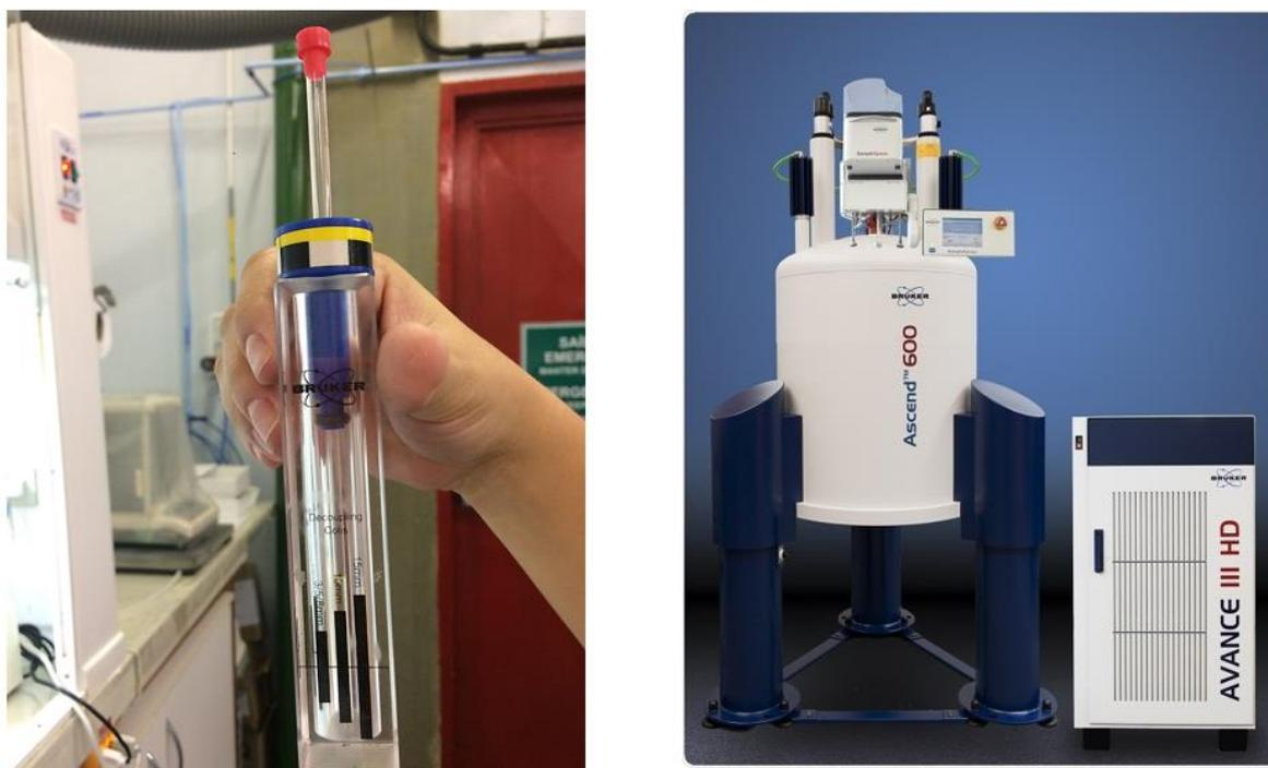
**Figura 6.** Tubo de RMN  $^1\text{H}$  e espectrômetro de ressonância magnética nuclear.
