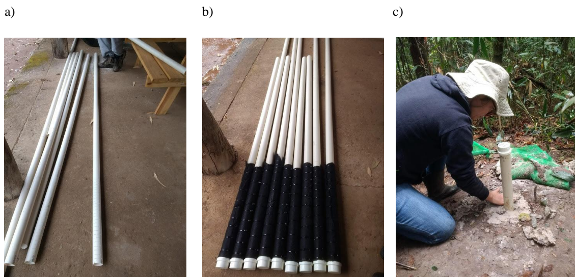
Figura 21: Processo de confecção e instalação dos poços nas áreas invadidas pela espécie Hedychium coronarium e não invadidas de Floresta Ripária no Córrego do Cortado (Martinho Prado Jr.). (a) Tubo de PVC de 60 mm cortado e perfurado, (b) revestido com manta geotêxtil e “cap” para que a água subterrânea fosse capaz de adentrar no tubo. (c) Instalação do poço no solo perfurado com o trado manual para que fosse possível o monitoramento do lençol freático durante os 12 meses de estudo.
