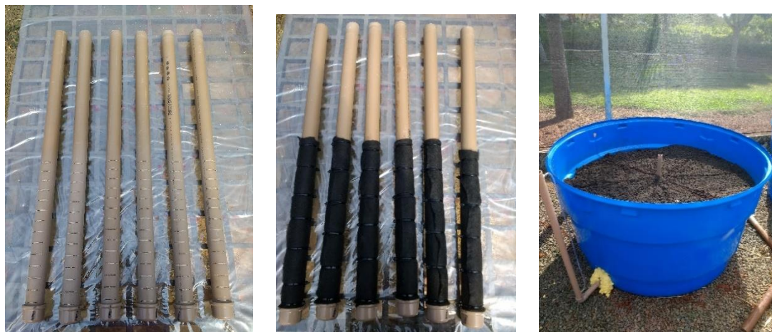
Figura 5: Imagem dos tubos de PVC: (a) perfurados, (b) revestidos de manta geotêxtil e (c) inseridos no lisímetro.
