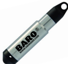
Figura 6: Diver utilizado para medir o nível de água nos lisímetros (a) e Baro Diver utilizado para medir a pressão atmosférica local (b). Os divers foram inseridos em um tubo de PVC no centro de cada lisímetro e realizavam as medidas do nível de água a cada 15 minutos, por um período de 14 meses.
