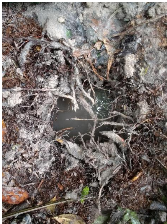
Figura 20: Processo de perfuração do solo com o trado manual para a instalação dos poços (a) e água aflorando no solo já perfurado (b). Foram instalados poços nas áreas invadidas pela espécie Hedychium coronarium e não invadidas de Floresta Ripária no Córrego do Cortado (Martinho Prado Jr.), totalizando 10 poços.
