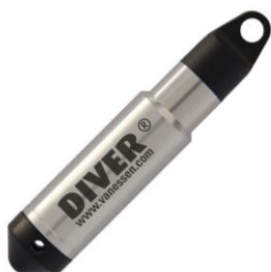
Figura 6: Diver utilizado para medir o nível de água nos lisímetros (a) e Baro Diver utilizado para medir a pressão atmosférica local (b). Os divers foram inseridos em um tubo de PVC no centro de cada lisímetro e realizavam as medidas do nível de água a cada 15 minutos, por um período de 14 meses.
