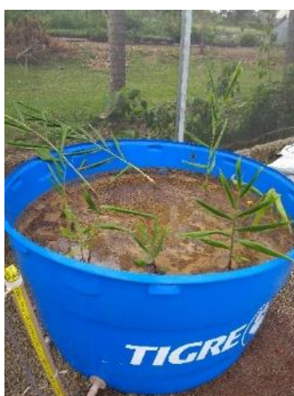
Figura 2: Etapas do processo de montagem do lisímetros na Secretaria de Gestão Ambiental e Sustentabilidade (SGAS) da Universidade Federal de São Carlos (UFSCar): (a) Esquema dos lisímetros utilizados no experimento de evapotranspiração; (b) imagem da brita; (c) ) areia; (d) terra vegetal e solo horizonte A2; (e) lisímetro simulando um ambiente totalmente invadido pela espécie Hedychium coronarium ; e (f) lisímetro simulando um ambiente não invadido e com a presença das espécies nativas (Bromeliacea, Euterpe edulis , Tapirira guianensis e Croton urucurana ).
