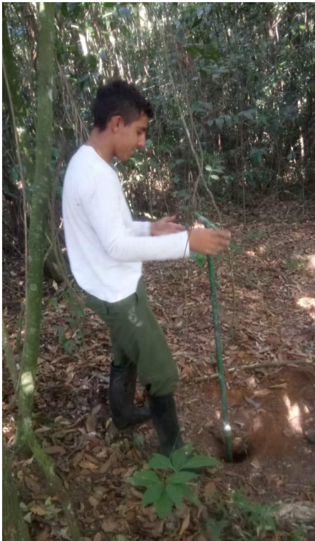
Figura 20: Processo de perfuração do solo com o trado manual para a instalação dos poços (a) e água aflorando no solo já perfurado (b). Foram instalados poços nas áreas invadidas pela espécie Hedychium coronarium e não invadidas de Floresta Ripária no Córrego do Cortado (Martinho Prado Jr.), totalizando 10 poços.
