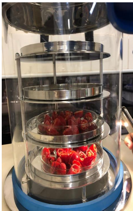
Figura 6. Amostras dos frutos de pimentas, no processo de secagem por liofilização. UFSCar, Araras, SP, 2019.
