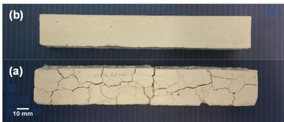
Figura 4.28 Imagens de amostras secas a 110^{\circ}\text{C} por 24 horas: (a) composição A, com magnésia cáustica QMAG 200 AR e alumina hidratável, (b) composição C, com magnésia cáustica, alumina hidratável e ácido fórmico.
