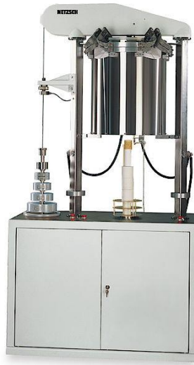
Figura 4.4: Equipamento NETZSCH-421 utilizado para os ensaios de sinterabilidade assistida e refratariedade sob carga.
