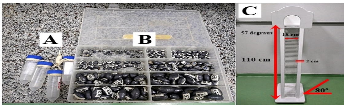
Figura 10: Equipamentos utilizados para a sessão de TR. A) Tubos cônicos utilizados para colocar os pesos B) Pesos utilizados; C) Escada utilizada para a escalada.
