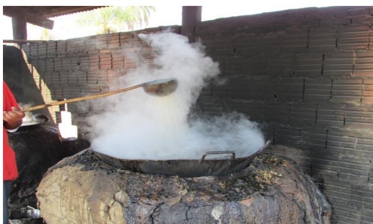
Figura 6: forno e tacho, fase inicial da produção de rapadura. Foto: autora 2016
