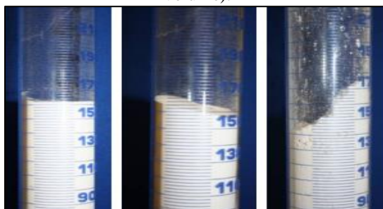
Figura 2.14. - Exemplo de como os pós se acomodam em testes de compactação quasi -estáticos. Da esquerda para a direita: Talco (fácil inferência do volume), lactose e calcário (difícil inferência do volume).
