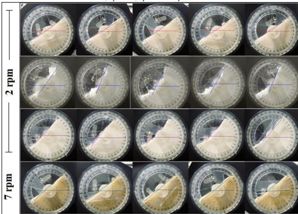
Figura 4.8. - Imagens obtidas de vídeos gravados durante o escoamento de açúcares em cilindro rotativo. Cada fileira representa imagens consecutivas de um tipo de açúcar. Fileiras (de cima para baixo): Açúcar GS, açúcar IS, açúcar RS e açúcar VS.
