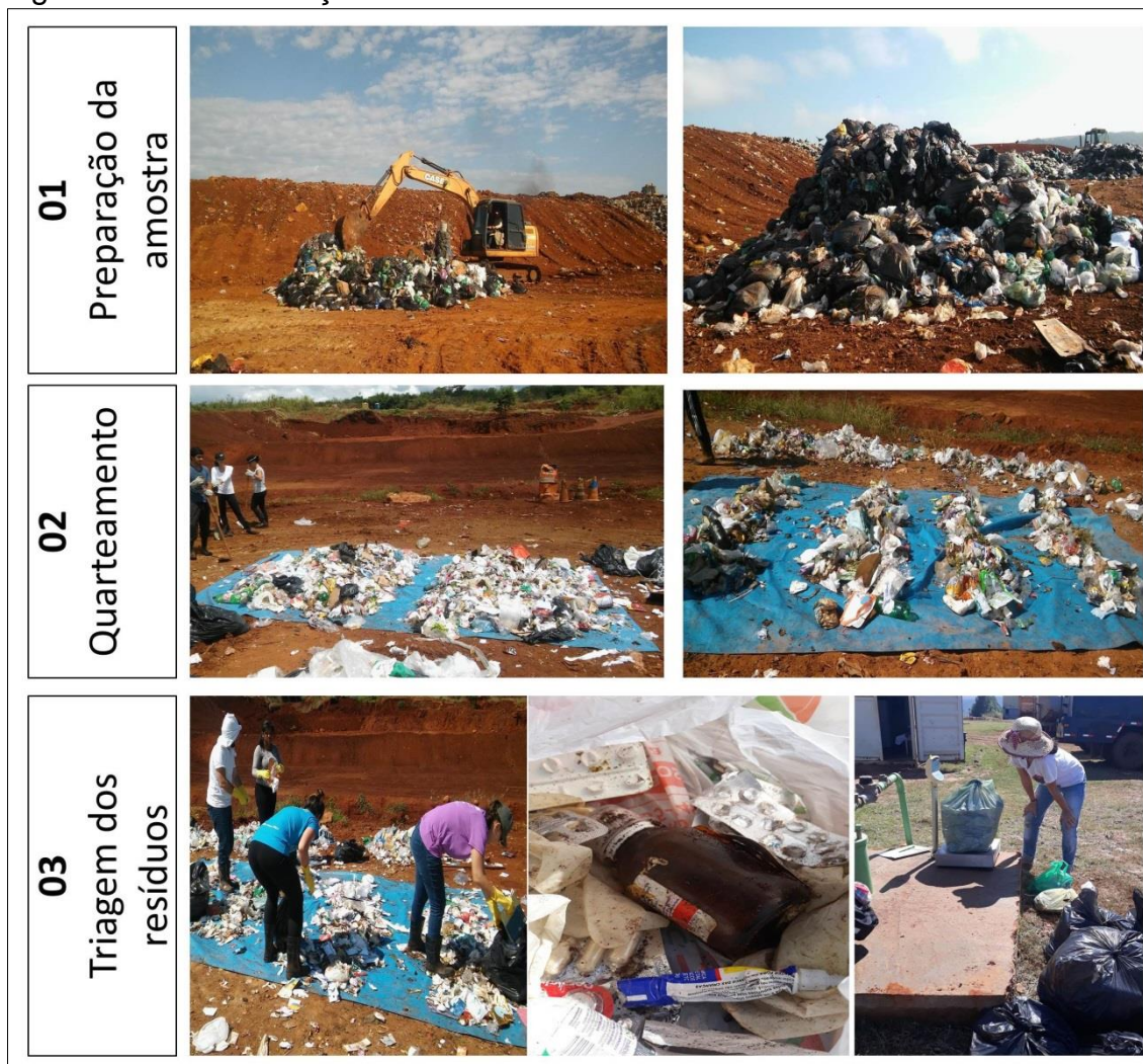
Figura 9 - Caracterização dos resíduos domiciliares no aterro
