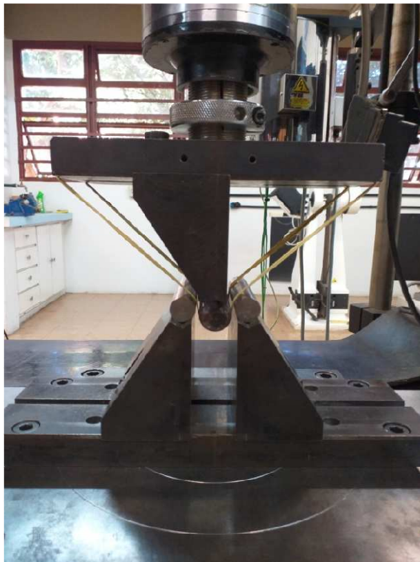
Figura 4.3 - Montagem do ensaio de dobramento em máquina universal de tração.
