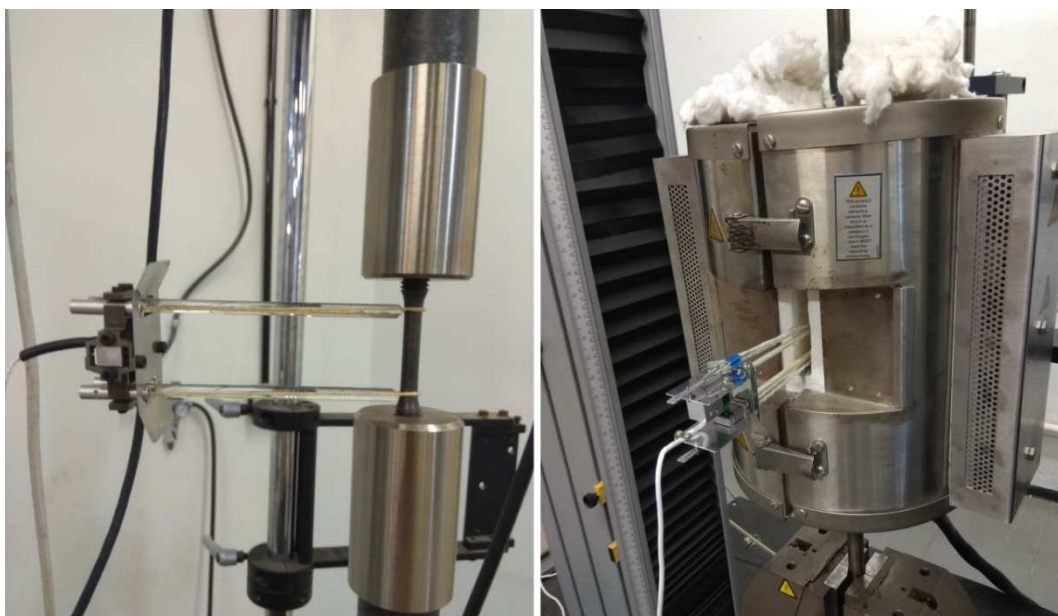
Figura A.4 - Máquina de ensaios de fadiga utilizada na segunda tentativa para medida de tensão vinculado ao efeito de memória de forma.
