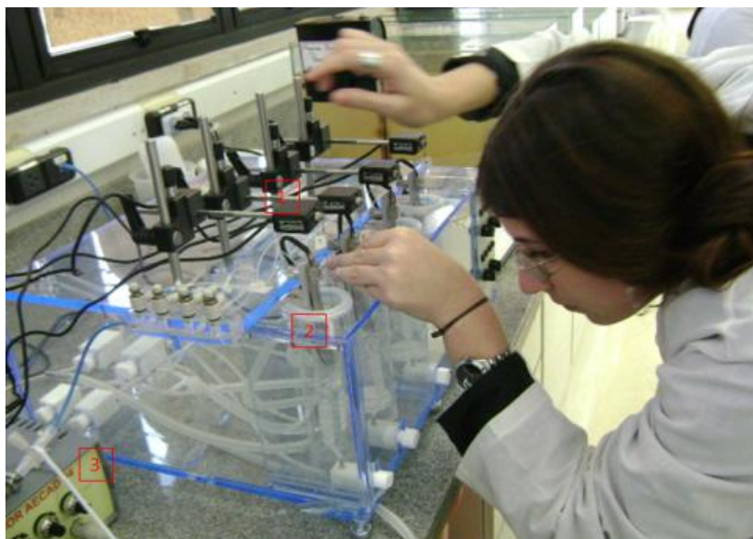
Figura 14 - Método de encaixe das tiras ventriculares entre o transdutor de força e o eletrodo de platina. Notar: 1- Transdutor de força; 2- Cubeta de 20 mL; 3- Amplificador.
