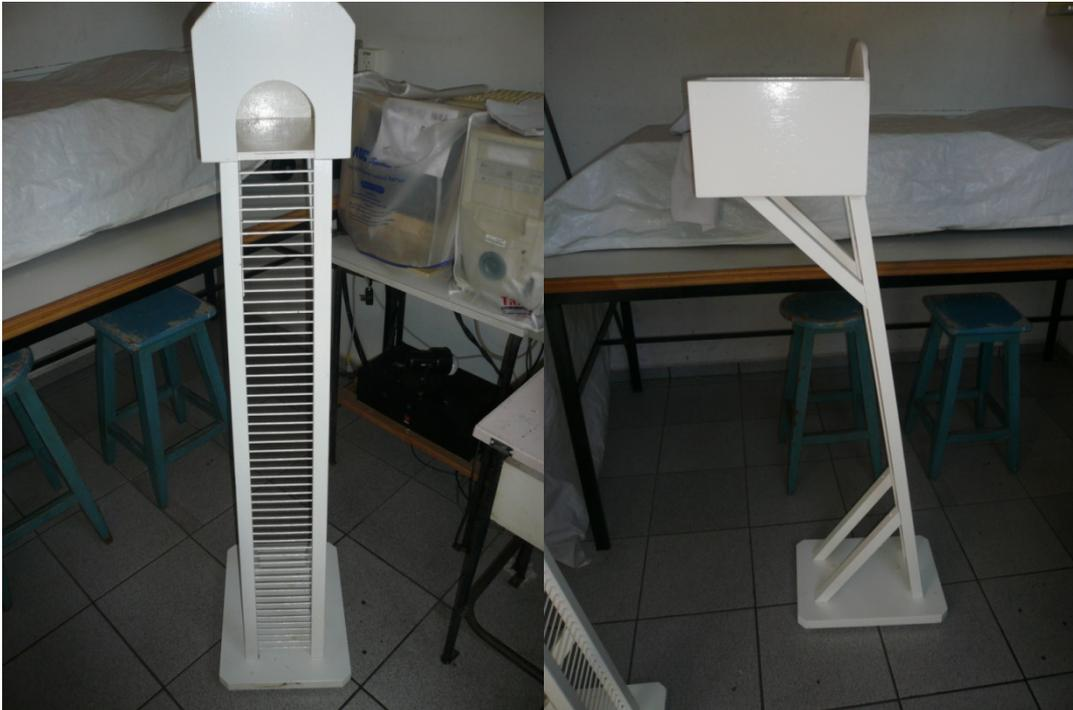
**Figura 4.** Escada de madeira utilizada no protocolo de exercício resistido. Contém 110cm de altura, com degraus de ferro e inclinação de 80 graus. Vista frontal (painel à esquerda) e vista lateral (painel à direita).
