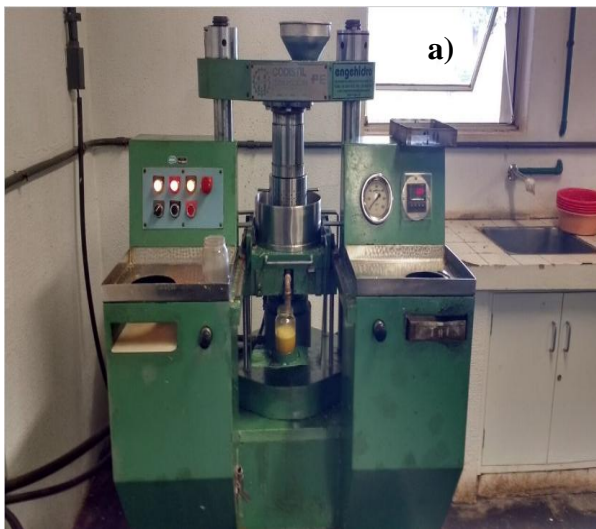
Figura 17. Prensagem hidráulica para extração do caldo (a); filtração e clarificação do caldo para determinação dos caracteres tecnológicos.
