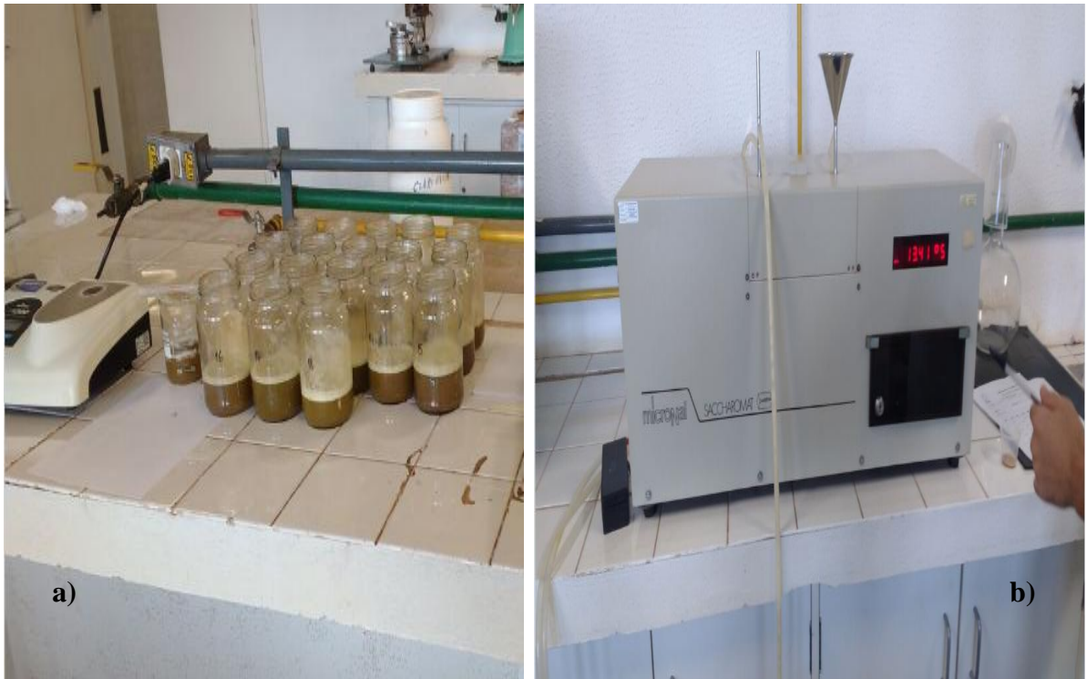
Figura 18. Leitura do °Brix em refratômetro de bancada (a); Leitura da Pol em sacarímetro digital.
