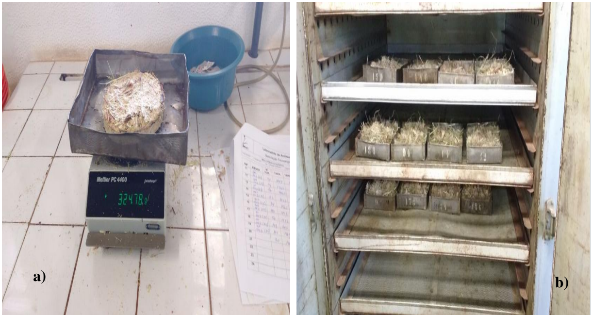
Figura 19. Determinação do PBU (Peso do Bolo Úmido) (a); determinação do PBS (Peso do Bolo Seco) (b), para cálculo do teor de Fibra.
