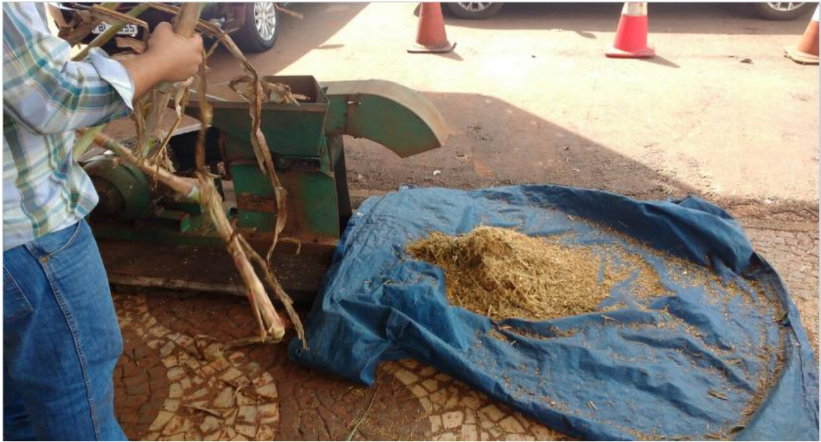
Figura 16. Processamento das amostras em máquina forrageira para determinação de matéria seca, umidade e teores nutricionais da parte aérea.
