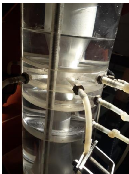
Figura 8 - Visão aproximada do sistema de injeção em um lavador Venturi
