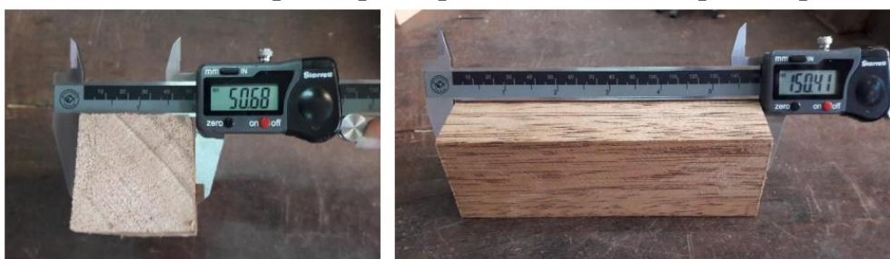
Figura 3.4. Dimensões dos corpos de prova para o ensaio de compressão paralela às fibras
