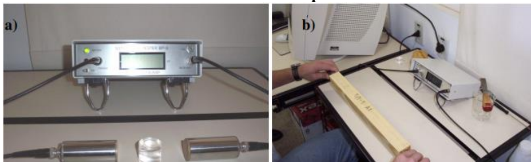
Figura 2.4. Equipamento de ultrassom Steinkamp, modelo BP 5: a) e b) obtenção da leitura do tempo
