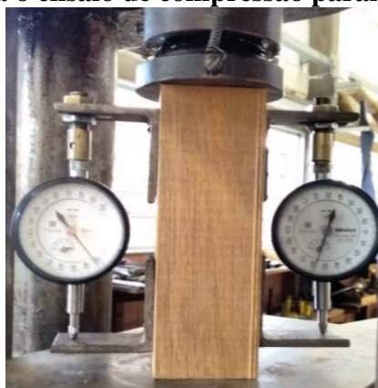
Figura 3.6. Posicionamento do corpo de prova e dos relógios comparadores na máquina de ensaio para o ensaio de compressão paralela às fibras
