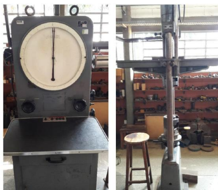
Figura 3.1. Máquina universal AMSLER
