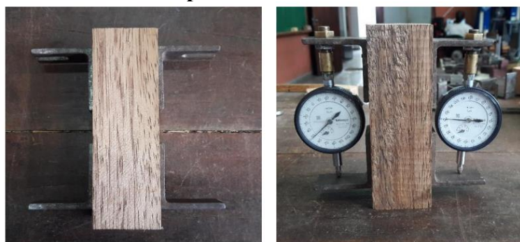
Figura 3.5. Fixação dos relógios comparadores nos corpos de prova de compressão paralela às fibras
