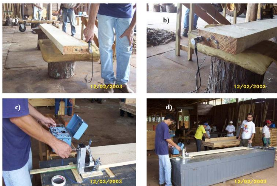
Figura 2.3. Ensaio nas peças de madeira: a) e b) detalhes dos acelerômetros c) e d) detalhes dos aparatos utilizados
