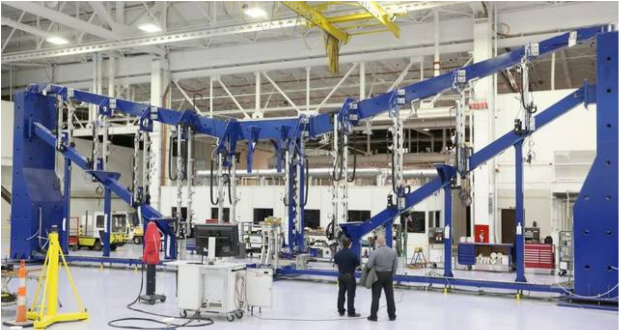
Figura 9: Gabarito de montagem das asas do Cessna Citation Longitude . Fonte: The Wichita Eagle (2017)
