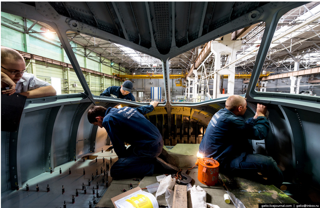
Figura 11: Montagem do interior de um Sukhoi Super Jet 100.
