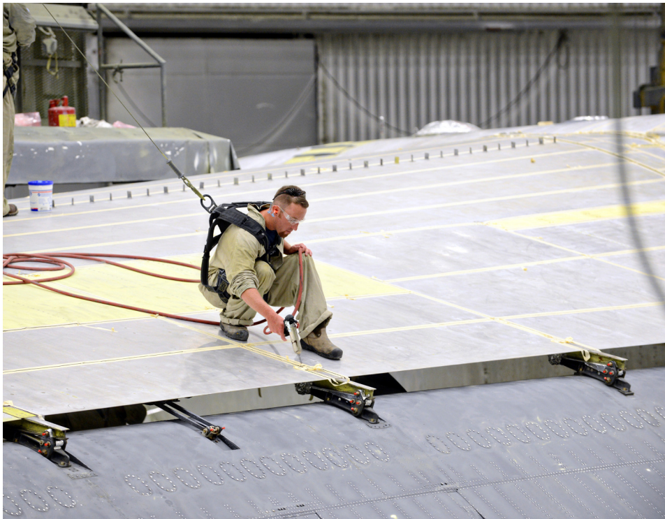
Figura 12: Selagem de interfaces de um AC-130J Ghostrider . Fonte: Tinker (2017)
