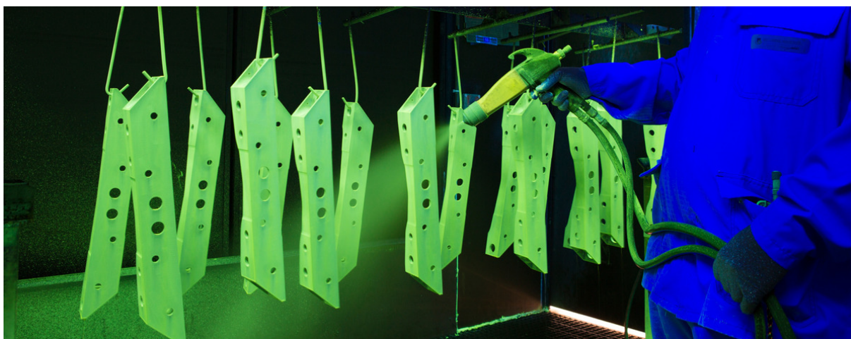
Figura 3: Processo de pintura de aeropeças. Fonte: Figeac-Aero (2017).
