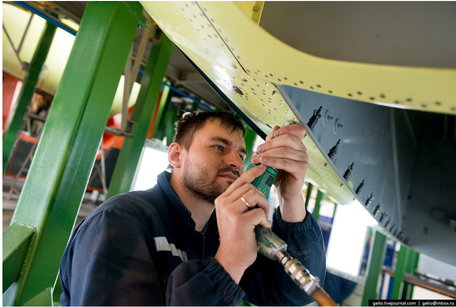
Figura 6: Operário realizando operações de furação na montagem estrutural de um SU-34 russo, na planta de Novosibirsk. Fonte: Asian Defence News (2017)
