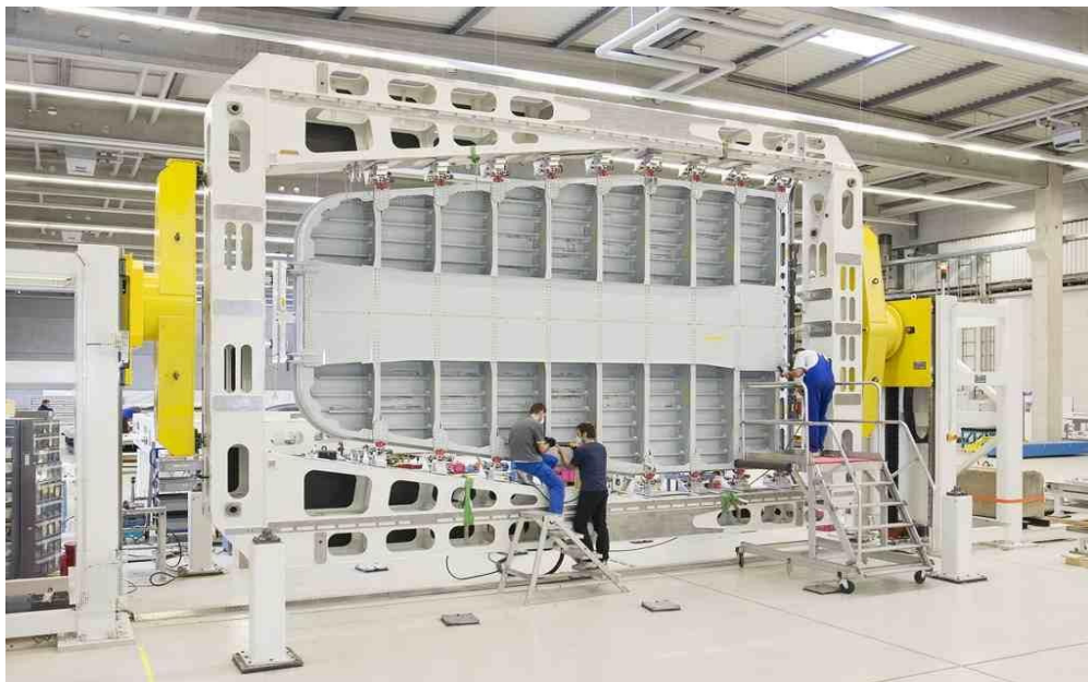
Figura 10: Gabarito de montagem da porta superior traseira do A400M Atlas. Fonte: Composite World (2017)
