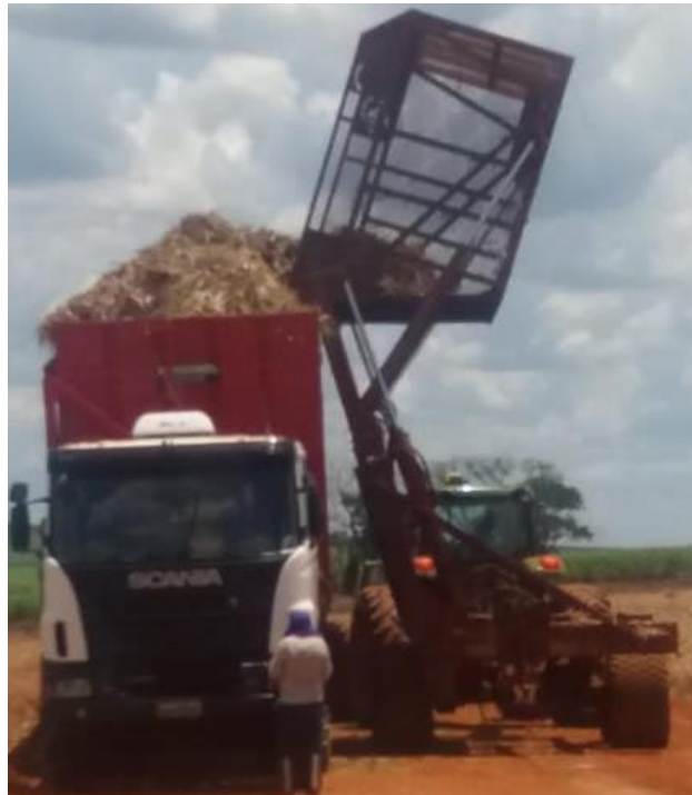
Figura 9 - Descarregamento do transbordo no caminhão
