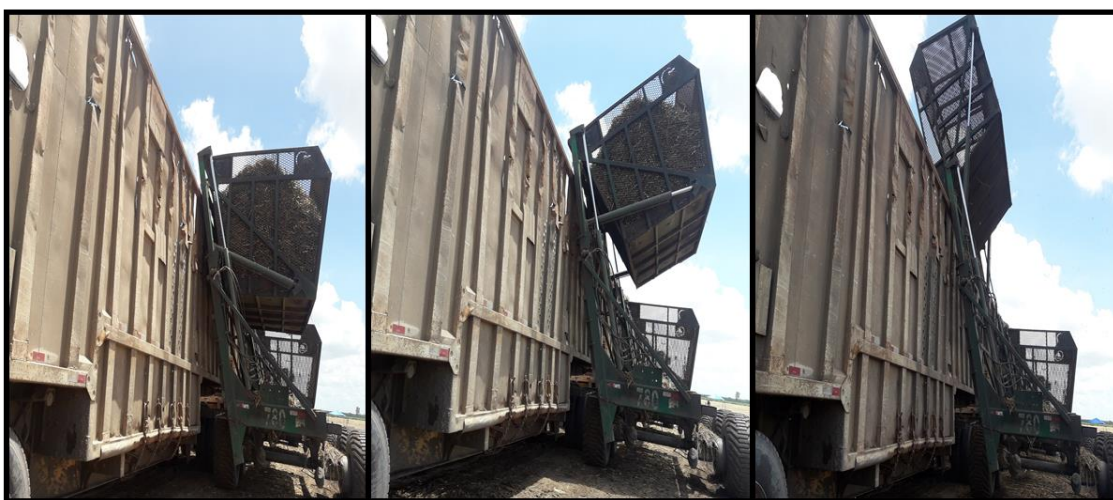
Foto 8 Sistema de colheita mecanizada – operação do transbordo
