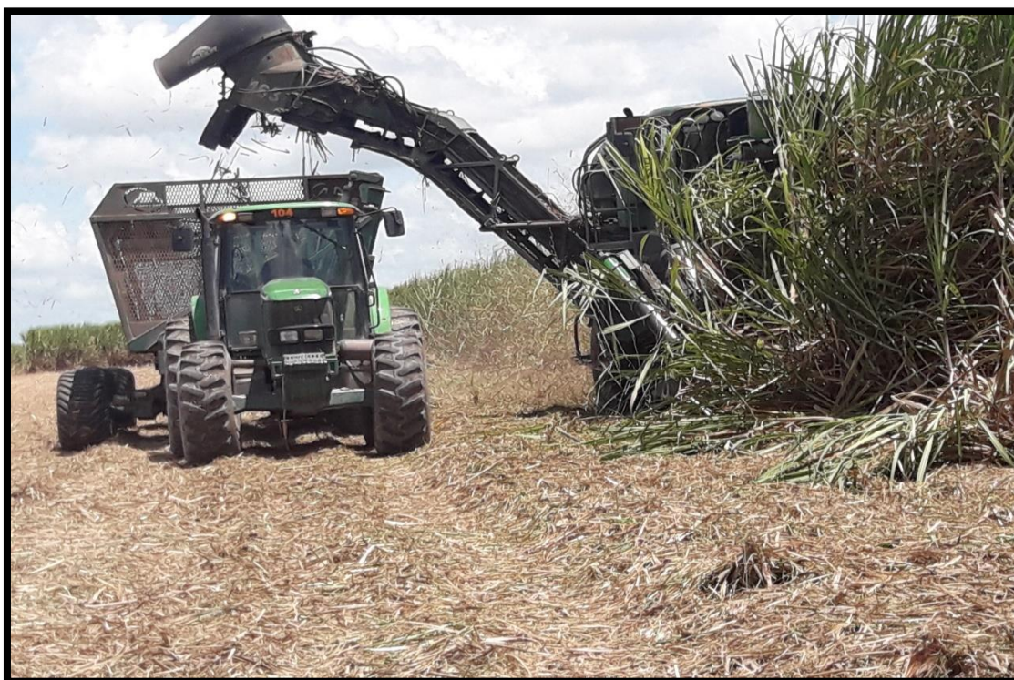
Foto 7 Sistema de colheita mecanizada – corte e carregamento
