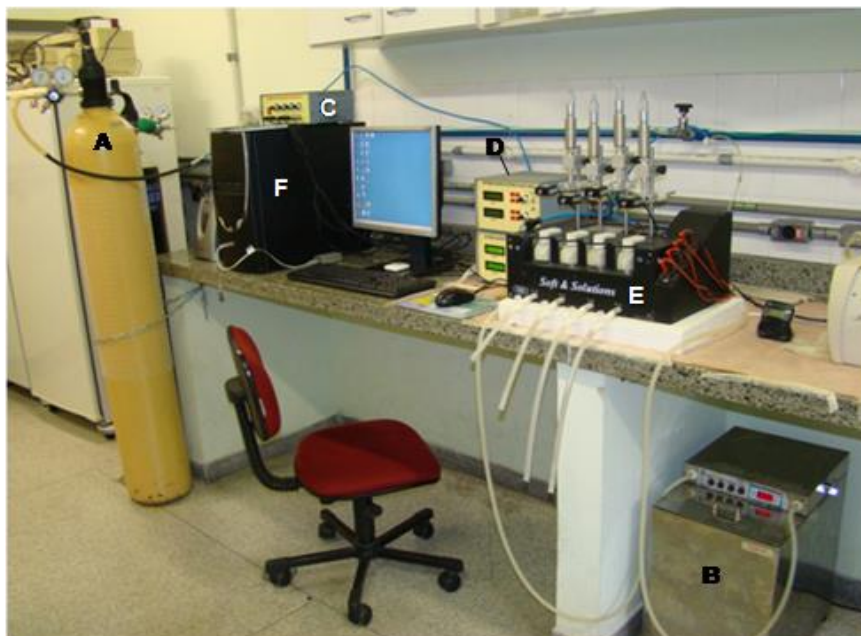
Figura 10. Set experimental utilizado para a obtenção dos registros da contração isométrica das tiras ventriculares do cascudo: A. cilindro de mistura carbogênica; B. banho termostático; C. amplificador de força; D. estimuladores elétricos; E. banho com quatro cubetas; F. sistema informatizado com placa de aquisição e tratamento dos dados.
