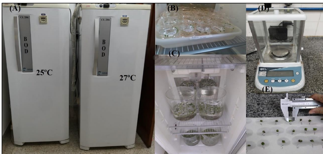
Figura 2. Bioensaios com Ricciocarpus natans expostas a metais: (A) Incubadoras utilizadas para controle de temperatura e iluminação, (B) bioensaios de crescimento com as diferentes concentrações de metais e indivíduos de R. natans , 5 repetições, (C) bioensaios de fisiologia com diferentes as diferentes concentrações de metais e indivíduos de R. natans , (D) balança utilizada para análise de biomassa da R. natans , (E) determinação da largura de R. natans através do paquímetro.
