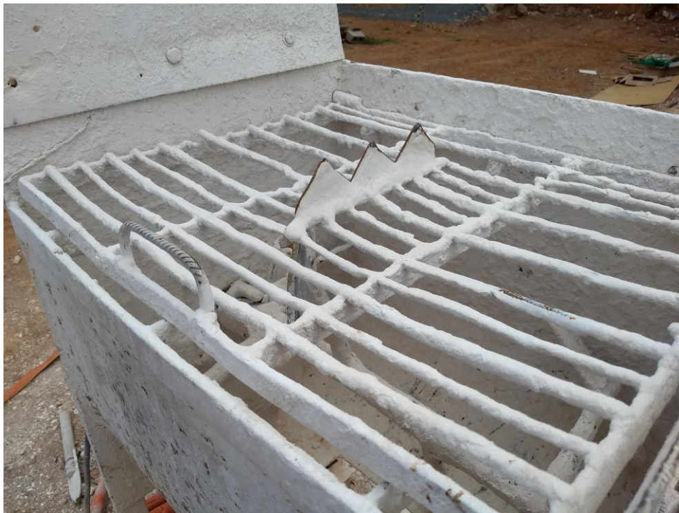
Figura 64 - Os dentes ajudam a rasgar o saco, agilizando o processo de colocar o material no equipamento
