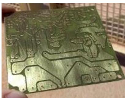
Figura 42 - Placa de circuito impresso produzida.
