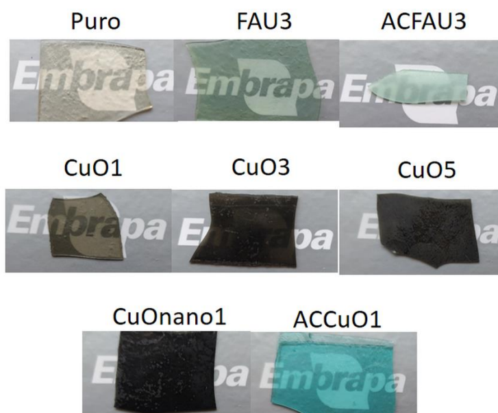
FIGURA 4.22: Imagens dos filmes compósitos de amido com inserção de CuO comercial ou nanoparticulado, e com adição de FAU.
