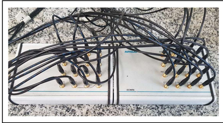
Figura 31. Fotografia do módulo de multiplexação AUTOLAB (MUX).
