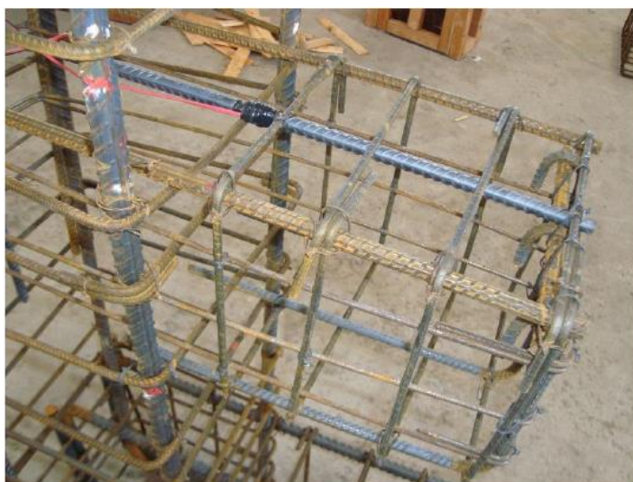
Figura 5-9: Strain gages no tirante do consolo do modelo PCD
