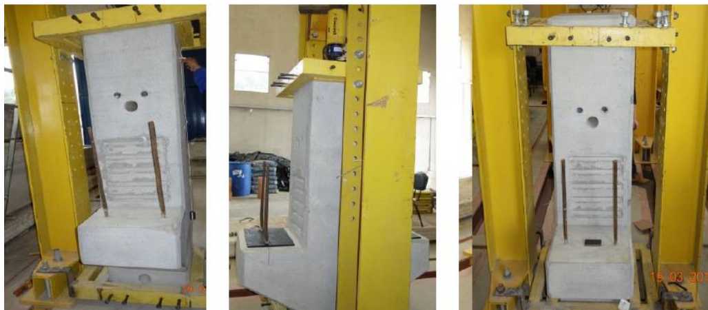
Figura 5-11: Protótipo da ligação viga-pilar ensaiada no NETPRE
