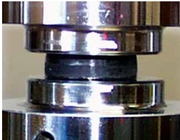
Figura 4-31: Ensaio a compressão simples de um elastômero com lubrificante na interface
