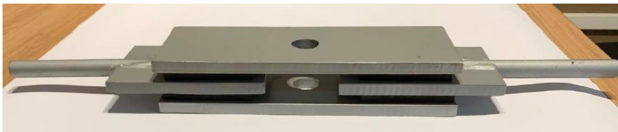
Figura 4-34: Protótipo para ensaio de cisalhamento puro de um elastômero
