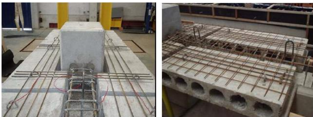
Figura 2-3: Detalhe do ensaio da ligação semirrígida do ensaio experimental
