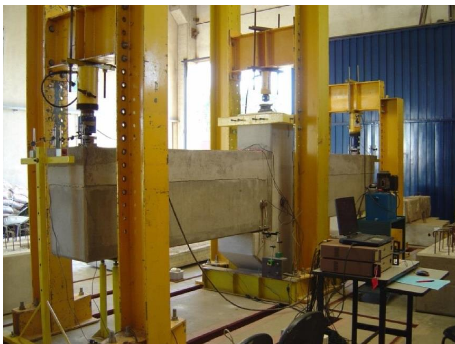
Figura 5-10: Protótipo da ligação viga-pilar ensaiada no NETPRE
