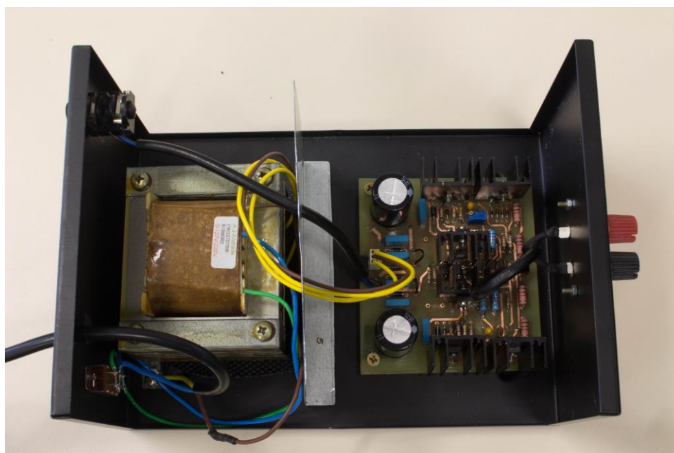
Figura 24 Transformador ao lado do circuito. Montados na caixa.
