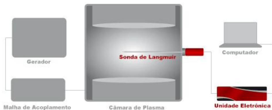
Figura 4 Disposição da sonda de Langmuir em uma câmara típica (LANGMUIR..., 2015).
