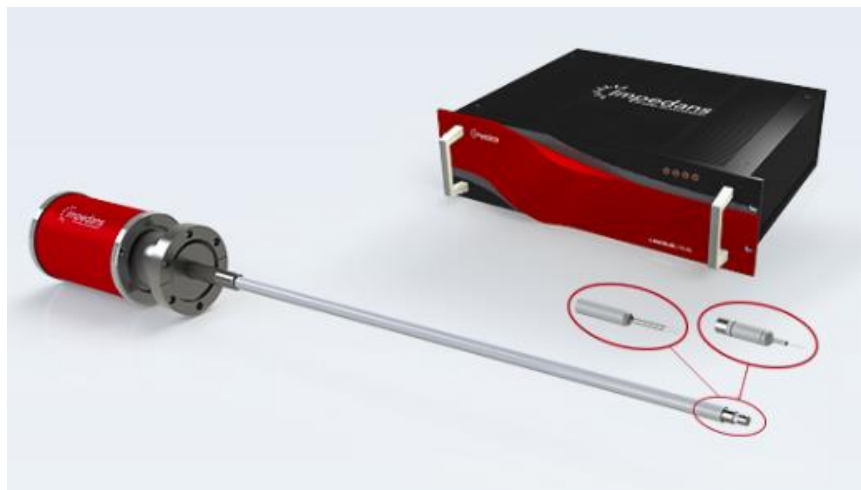
Figura 1 Sonda de Langmuir disponível no mercado, da empresa Impedans (LANGMUIR..., 2015).
