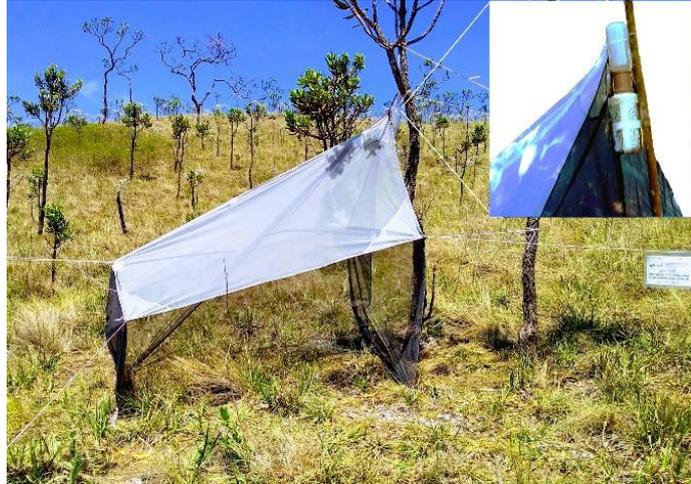
**Figura 4.** Armadilha Malaise montada em uma área de campo rupestre no Parque Nacional da Serra da Canastra, São Roque de Minas, MG. O frasco coletor é mostrado em detalhe à direita.
