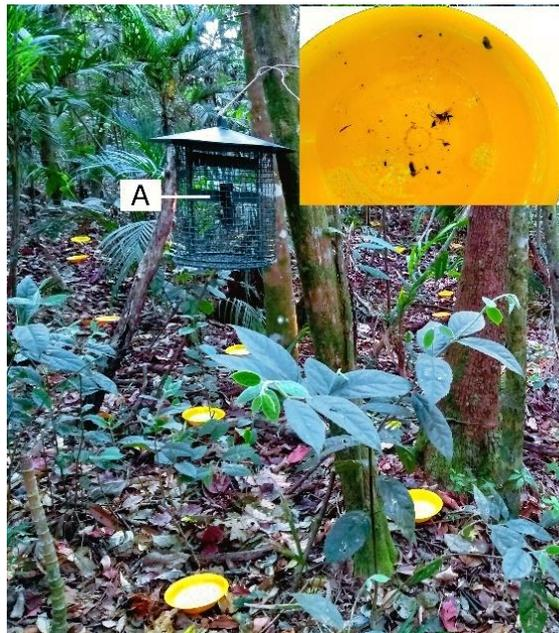
**Figura 3.** Armadilhas de Moericke em uma mata de galeria no Parque Nacional da Serra da Canastra, São Roque de Minas, MG. **A.** Dispositivo *Data Logger* utilizado para registrar variáveis ambientais (temperatura, umidade relativa e ponto de condensação) durante o período de coleta.
