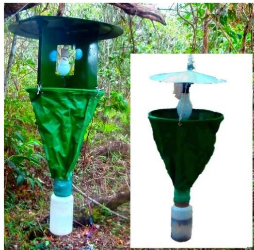
**Figura 5.** Armadilhas luminosas utilizados no Parque Nacional da Serra da Canastra, São Roque de Minas, MG. A armadilha da direita difere por não possuir as aletas na região da lâmpada.
