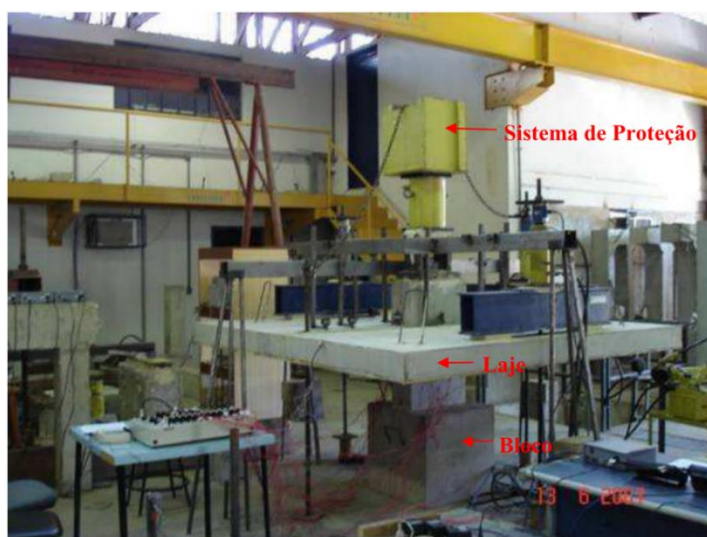
Figura 5.3: Sistema de ensaio realizado por Souza (2008)
