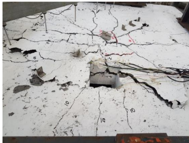
Figura B.12: Modelo experimental LF3 ensaiado por Lourenço (2018) após a ruptura
