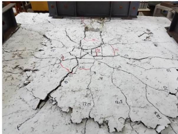
Figura B.17: Modelo experimental LF4 ensaiado por Lourenço (2018) após a ruptura
