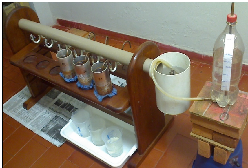
Figura 3 – Módulo experimental instalado no laboratório com permeômetro de carga constante.
