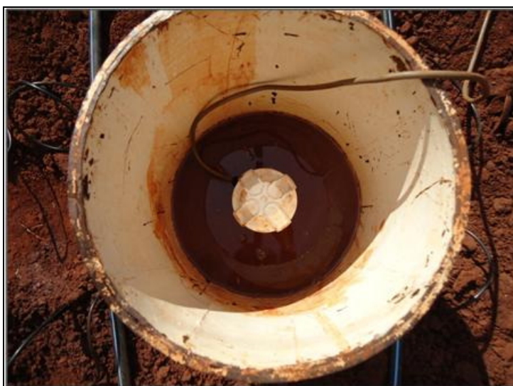
Figura 7 - Anel concêntrico acoplado ao solo para formação de lâmina d'água e saturação do solo.
