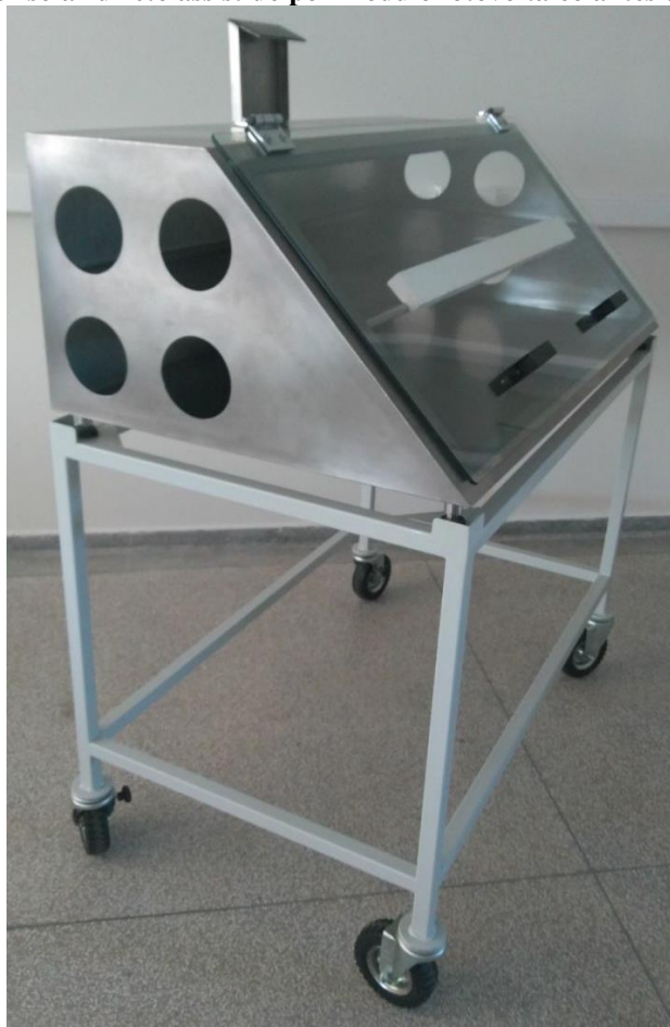
Figura 7 – Secador solar direto assistido por módulo fotovoltaico antes da instrumentação.
