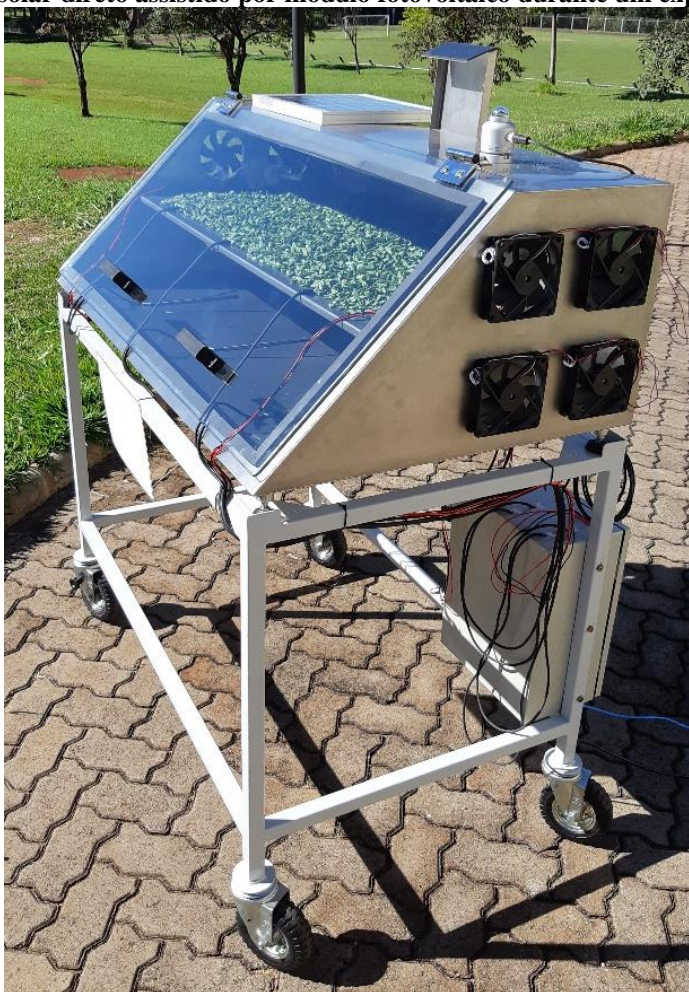
Figura 13 – Secador solar direto assistido por módulo fotovoltaico durante um experimento de secagem.
