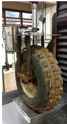
Figura 6 - Teste de compressão para determinação do coeficiente de rigidez vertical de um pneu.
