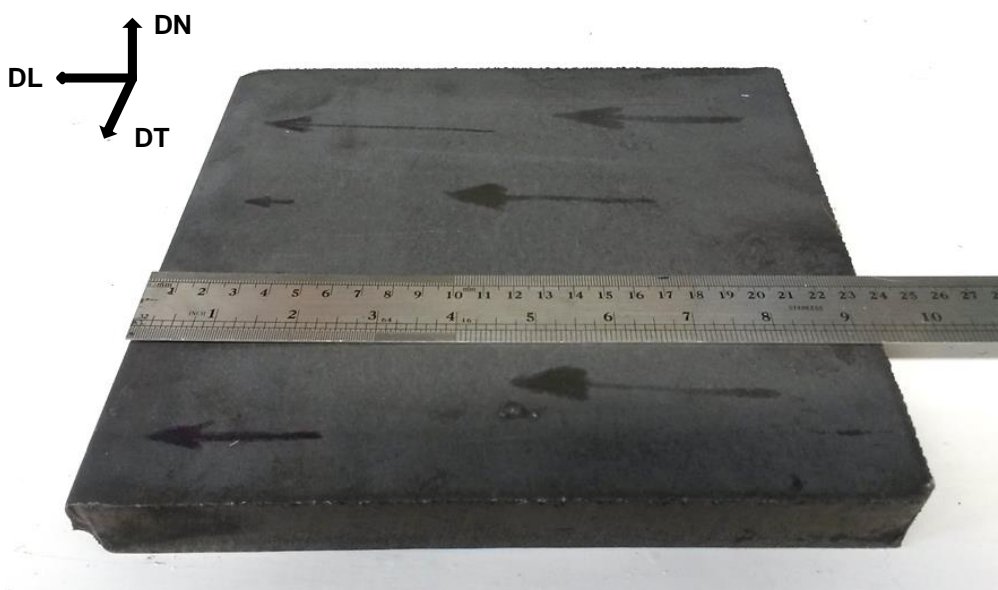
Figura 3.2 - Material CR. Dimensões: 235mm x 215mm x 28mm. As setas indicam a direção de laminação.
