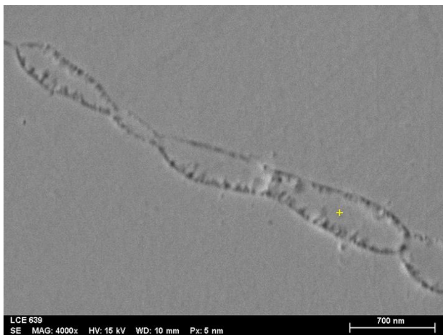
Figura 4.29 – Análise de EDS por pontos indicou uma composição aproximada de ~10%Cr após 2900,1 horas a 600°C.
