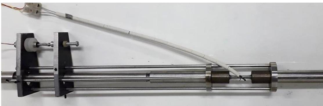
Figura 3.7 - Sistema de extensometria utilizado para a realização dos ensaios de fluência.
