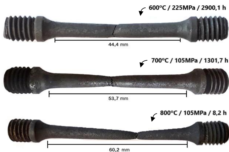
Figura 4.26 – Fotografia de três CP's após ensaios de ruptura por fluência.
