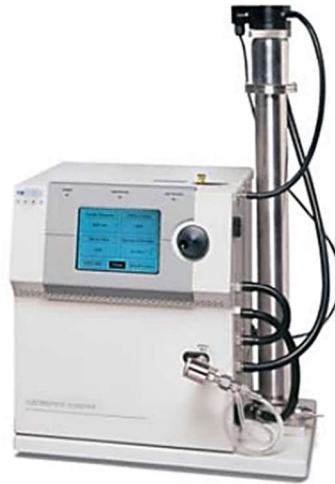
Figura 23. Classificador eletrostático da TSI, modelo 3080, com um analisador de mobilidade diferencial longo ( Long DMA ) da TSI, modelo 3081.
