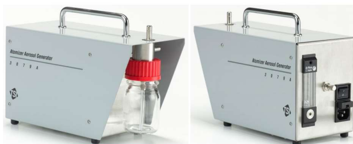
Figura 18. gerador de nanopartículas TSI, modelo 3079A, com vazão de aerossol ajustável.
