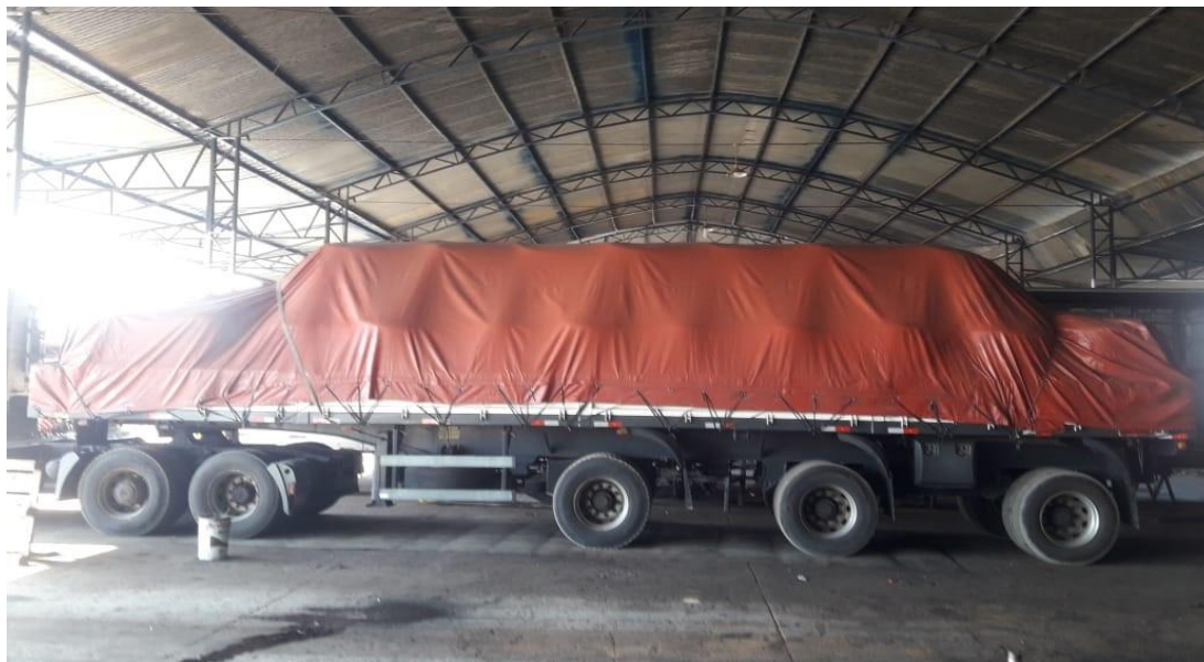
Figura 3 - Carreta Convencional carregada com a capacidade de 30 toneladas
