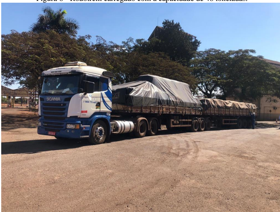
Figura 6 - Rodotrem carregado com a capacidade de 48 toneladas.
