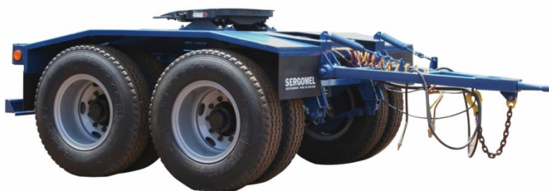
Figura 5 - Equipamento Dolly que auxilia na conexão dos semirreboques do Rodotrem
