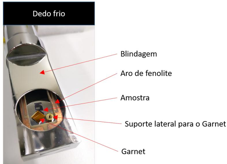
Figura 3.4: Exemplo de montagem padrão de uma amostra no dedo-frio.
