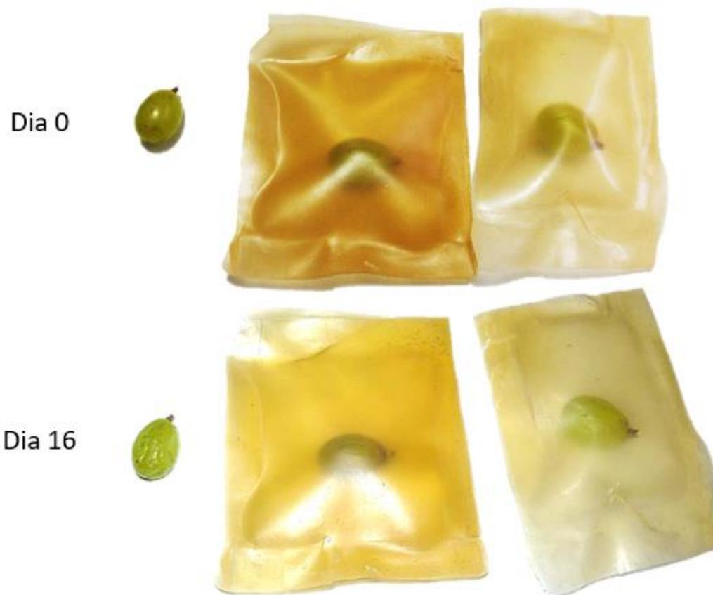
FIGURA 4.33: Ensaio de prateleira de uva Thompson utilizando os filmes 50 TPS : 50 PEC (meio) e 75 TPS : 25 PEC (direita). Uva sem embalagem para comparação à esquerda.
