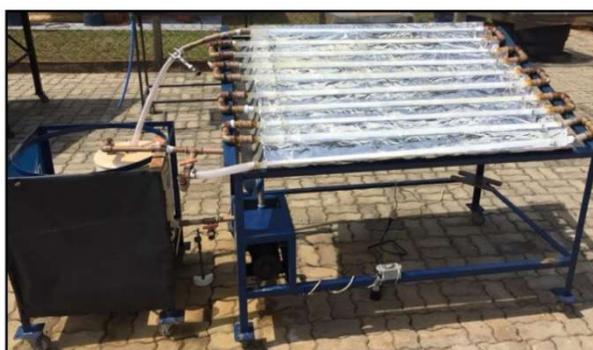
**FIGURA 12** - Visão frontal do reator solar montado do departamento de gestão de resíduos da UFSCar, utilizado para os experimentos de degradações.
