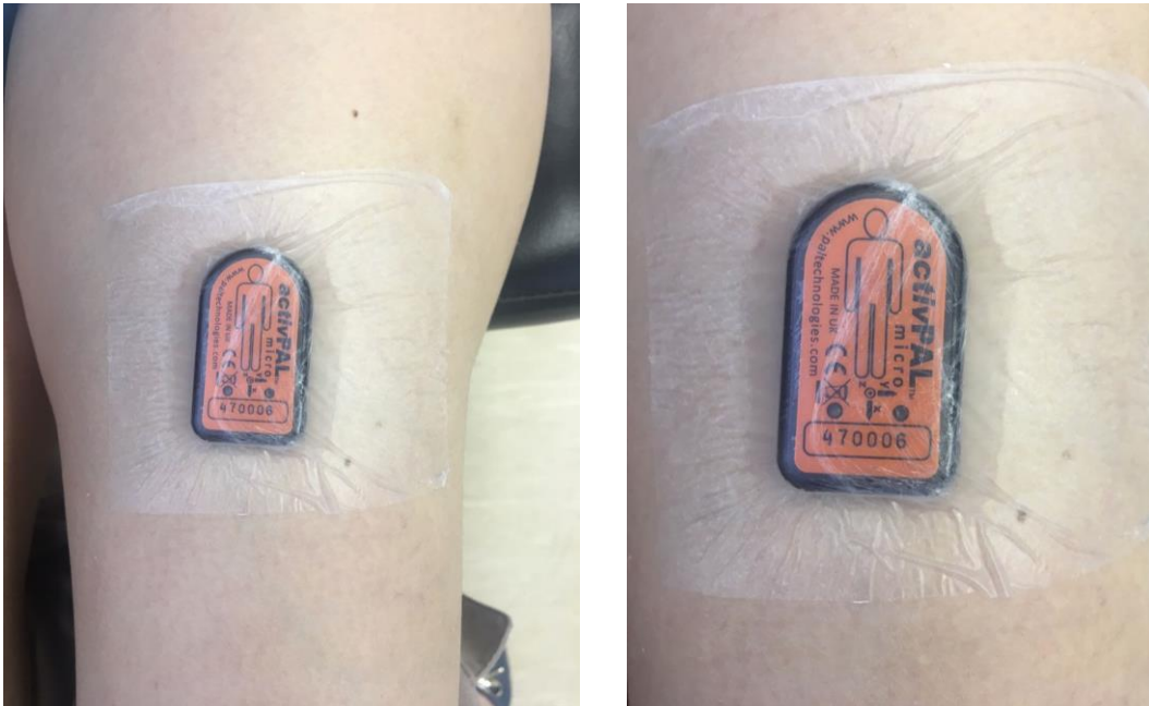
Figura 2: Posicionamento do actígrafo fixado no terço médio da região anterior da coxa direita.
