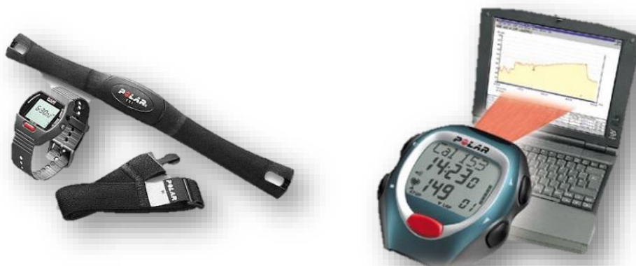
Figura 3. Ilustração do cardiofrequencímetro utilizado para captação e registro do sinal da frequência cardíaca e dos iRR. (Fonte: arquivo pessoal).
