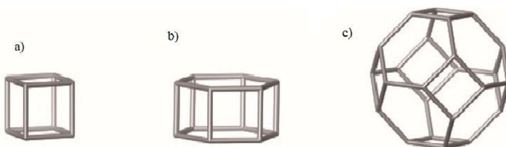
Figura 4: Exemplos de unidades secundárias estruturais das zeólitas
