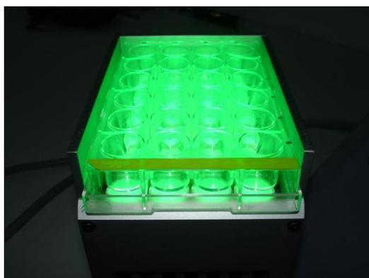
*Figura 6. Dispositivo de iluminação com 24 LEDs emitindo em 525 nm e irradiância de 7 mW/cm<sup>2</sup>.*
