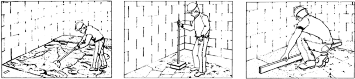
Figura 13: Execução da camada de contrapiso
