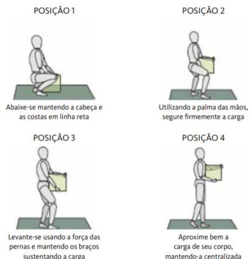
Figura 49: Elevação e movimentação de carga
