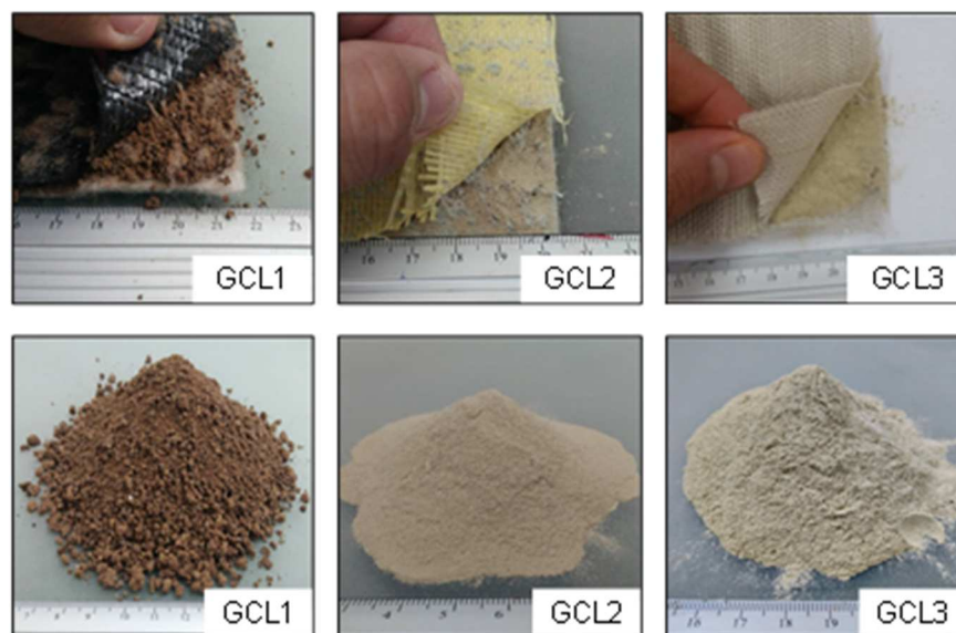
Figura 4.1 – Aspectos estruturais dos GCLs e respectivas bentonitas utilizados nesta pesquisa.
