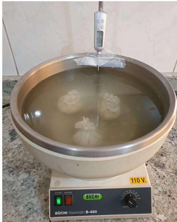
**Figura 6.** Amostras dos grãos submersas em água num banho termostático.
