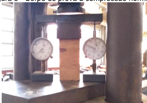
Figura 5 - Corpo de prova à compressão normal na prensa
