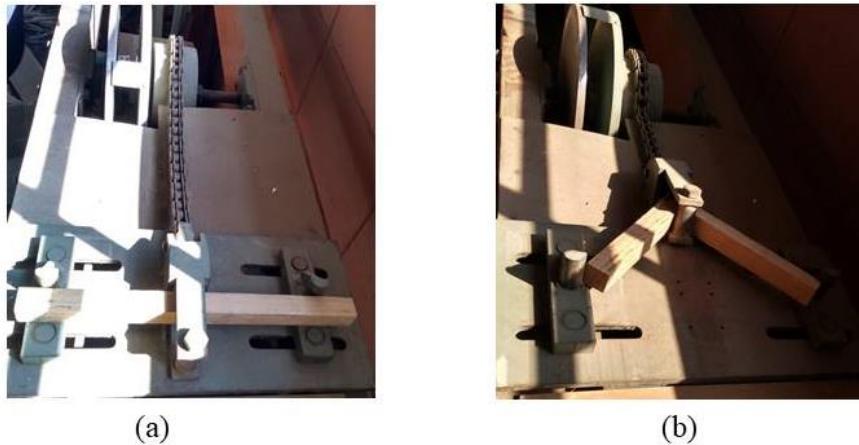
Figura 20 – Tenacidade e Resistência ao Impacto na Flexão - (a) Corpo de prova posicionado para ensaio (b) Ensaio finalizado
